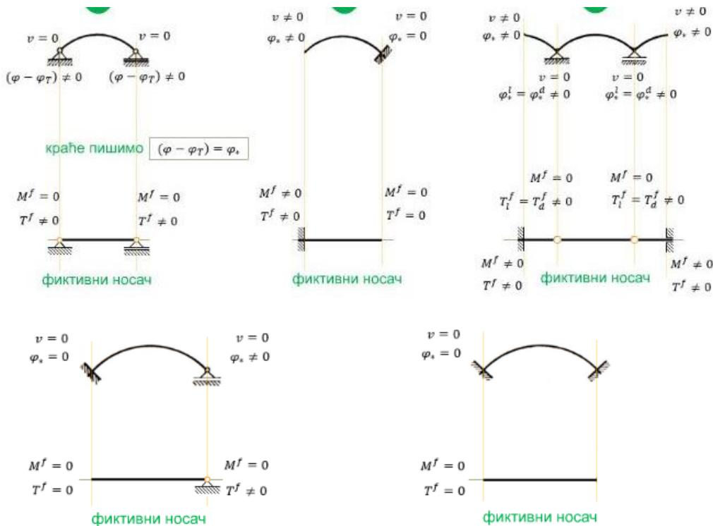
*Postoji mogućnost da fiktivni nosač bude kinematički labilan nosač!*
